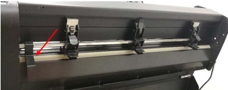
**Schritt 8** Drücken Sie die Taste „ENTER“, um die Größenbestimmung der Medienbreite zu starten.
