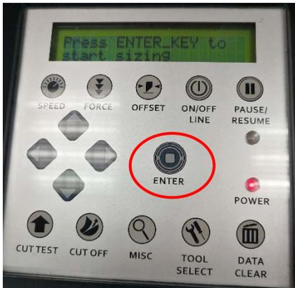
**Schritt 9** Gehen Sie in das Menü „MISC“, wählen Sie mit den Pfeiltasten links/rechts die Option „Adjust Paper“ und drücken Sie die Taste „ENTER“. Stellen Sie „Adjust Paper“ auf 22,5 mm und drücken Sie zur Bestätigung die Taste „ENTER“.
