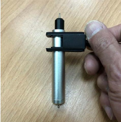
Stellen Sie sicher, dass das Werkzeug unten in das Halterohr eingesetzt ist und drehen Sie die Handschraube, um die Position zu fixieren.
