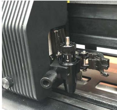
**Schritt 2** Ziehen Sie die Rändelschraube an, um den Werkzeugschlitten zu befestigen.
