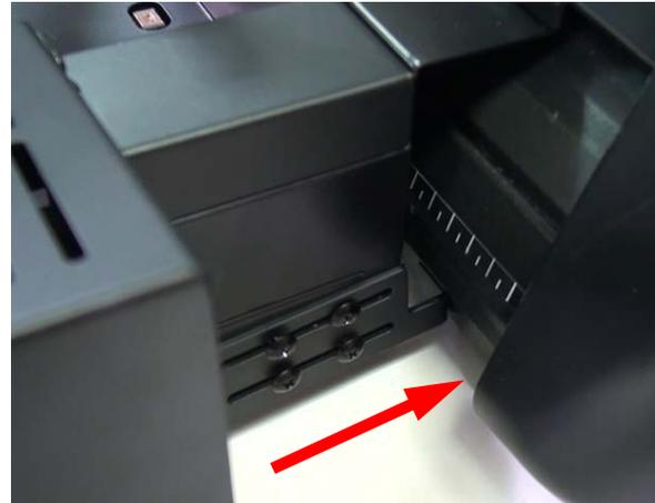
5. Lösen Sie die Schraube an der hinteren Arbeitsplatte.
