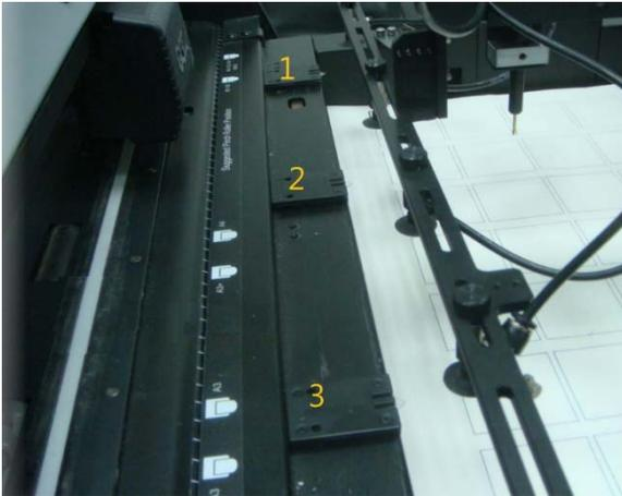
Ein magnetischer Medienseparator enthält einen Magneten, der zur Befestigung des Medienseparators an einer Bogenzuführung dient. Die Benutzer können den magnetischen Medienseparator bei Bedarf in die richtige Position bringen.
