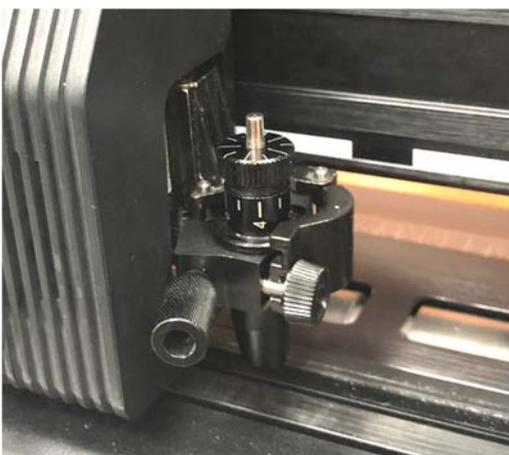
**Schritt 4** Gehen Sie in umgekehrter Reihenfolge vor, um den Klingenthaler zu entfernen.
