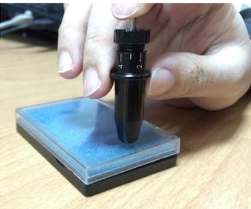
**Schritt 3** Stellen Sie die Klingenspitze auf die passende Länge ein, indem Sie den Klingenspitze-Justiererring im Uhrzeigersinn oder im Gegenuhrzeigersinn drehen.
