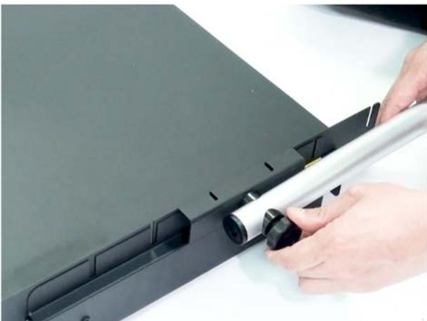
8. Setzen Sie den Medienstopper in die Nut des Medienauffangfachs ein. Der Medienstopper ist mit einem Magneten befestigt. Stellen Sie den Medienstopper je nach Größe des verwendeten Mediums in die richtige Position.
