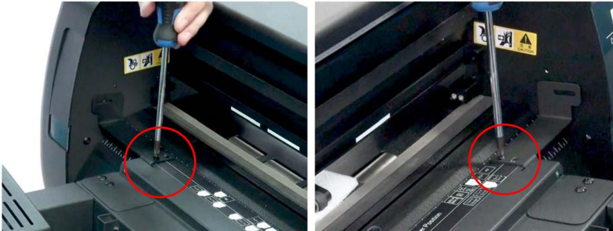
2. Ziehen Sie die Rändelschraube an, um die Verbindungshalterungen an der Seitenplatte des Jaguar V/RXII zu befestigen.
