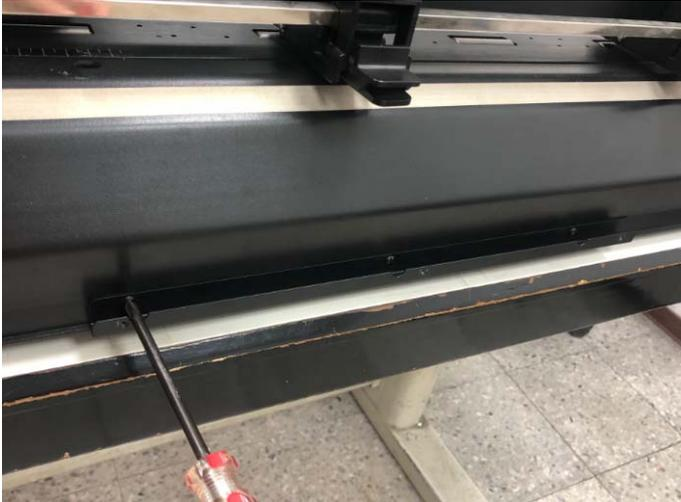
7. Montieren Sie die ausziehbaren Ständer
