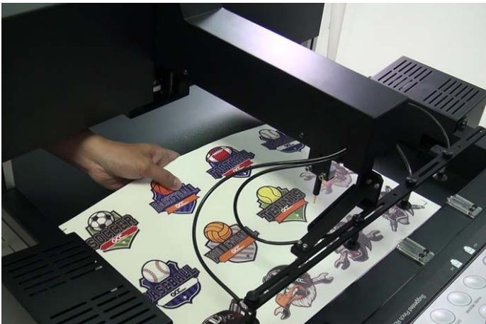
**Schritt 2** Setzen Sie die L-förmigen Medienblöcke so ein, dass sie den hinteren Rand des Blattmediums berühren.
