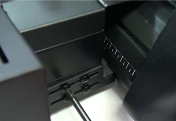
4. Drücken Sie die seitlichen Halterungen so, dass sie eng am Plotter anliegen, und ziehen Sie dann die Schrauben fest.
