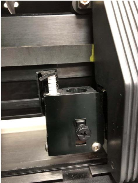
2. Stellen Sie sicher, dass sich der Zylinder in der Position „Unten“ befindet.
