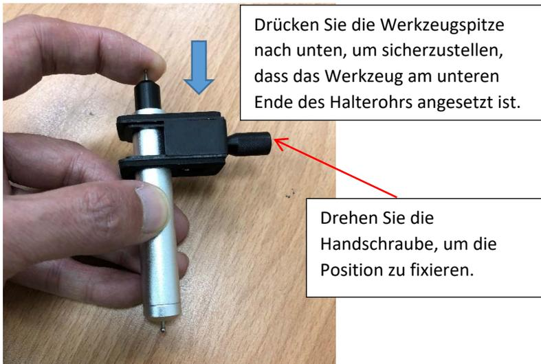
4. Legen Sie die Höheneinstellvorrichtung unter die Rillwerkzeugposition und setzen Sie den Rillwerkzeughalter ein (stellen Sie sicher, dass sich der Zylinder in der Position „Unten“ befindet).
