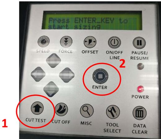
Die Standardwerte für die Schnittkraft und den Offset-Wert des Schnitttests sind 80 gf bzw. 0,275 mm. Drücken Sie die [PFEILTASTE], um den Werkzeugschlitten an die gewünschte Position zu bewegen. Drücken Sie dann die Taste [ENTER], um den Schnitttest durchzuführen.
