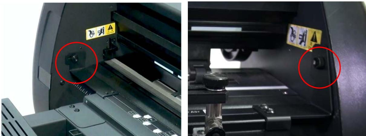
3. Lösen Sie die Schrauben an den seitlichen Halterungen der automatischen Zuführung.
